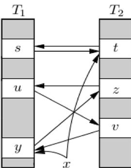
A chave pode não ter sucesso de inserção, quando os elementos ficam se reorganizando sem fim. Para evitar loops, faz-se um *rehash* (uma realocação) nas duas tabelas, utilizando-se duas novas funções hash.
